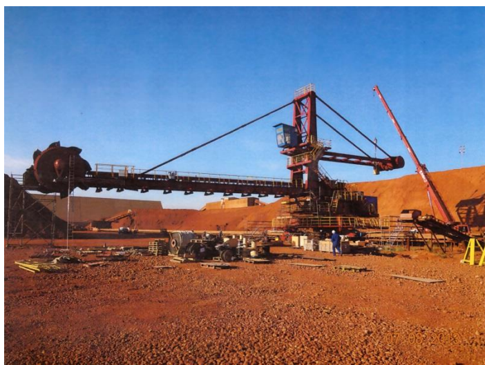
Производство и монтаж, многочерпаковый экскаватор, АОС – Stade (2013г.)
