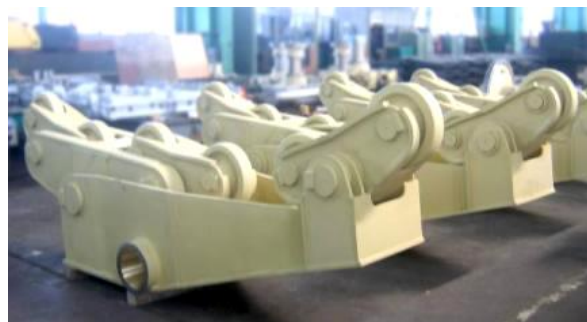
6- колесные тележки отвалообразователя
