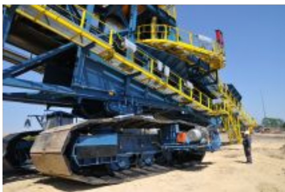
Odlagac jalovine na površinskom kopu. Detalj - gusenica Zoom
